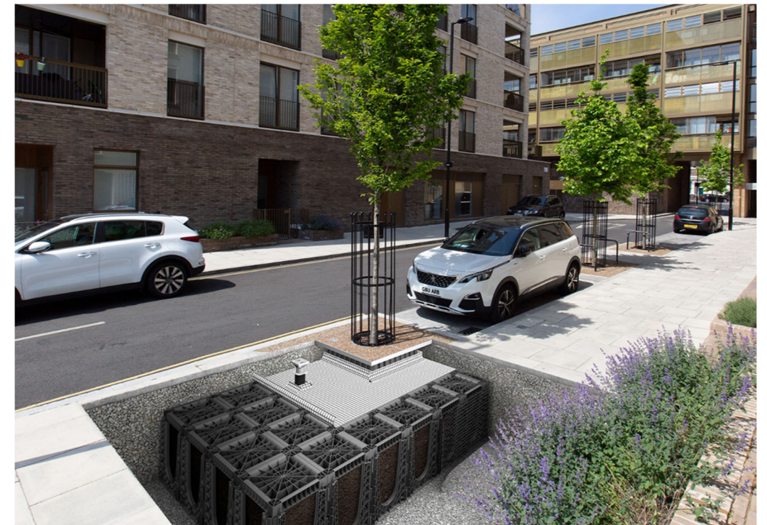
Imagen de celdas GreenBlue RootSpace.
